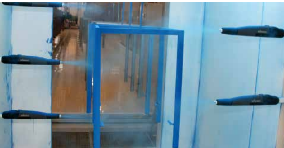
Mit Automatikpistolen werden rohe Metallteile in der modernen Kunststoffkabine von Mayr Schulmöbel gepulvert.
